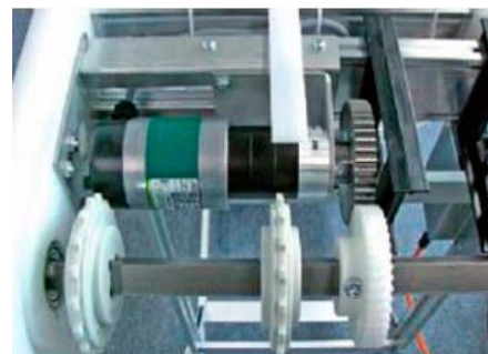
Silnik ROSYNC posiada wysoki stosunek wydawanej mocy do zajmowanej przestrzeni i jest idealny tam, gdzie jest ona ograniczona
